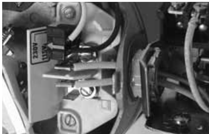
Figura 9: Tensión configurada para 115 voltios, tipo ficha.
