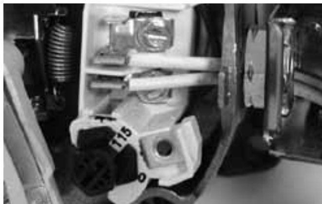
Figura 11: Tensión configurada para 115 voltios, tipo cuadrante.
