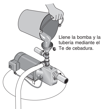
Figura 9: Cebadura de la bomba
