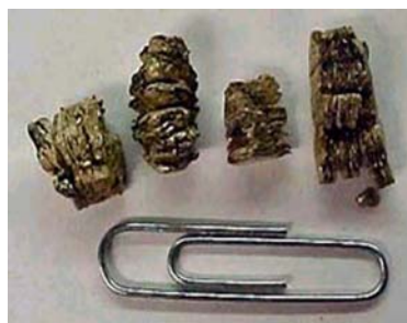
Tamaño de las partículas de vermiculita comparado con un clip de papel clip
