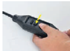
2. Press the «RESET» button, the indicator light turns red. 3. Press the «TEST» button, the indicator light turns off.
