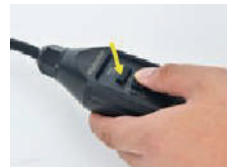
4. Press the «RESET» button, the indicator light turns red.
