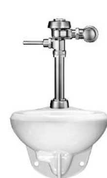
WETS 2050.1001-1.28 (1.28 gpf/4.8 Lpf) Manual HET Royal® Manual Flushometer and Wall Hung Water Closet
