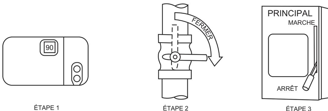
Figure 7 – Pour couper la climatisation électrique
