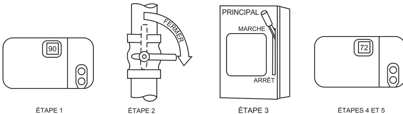
Figure 6 – Pour démarrer l'appareil de climatisation électrique
