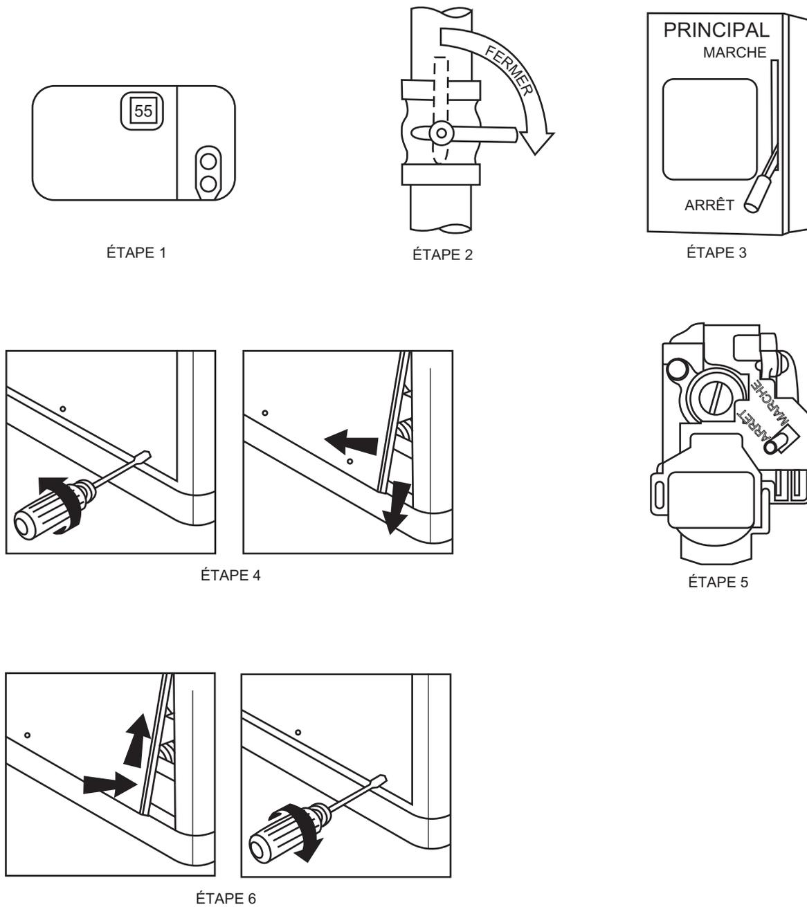
Figure 5 – Pour arrêter l'appareil à gaz
