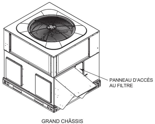
Figure 9 – Accès au filtre à grand châssis
