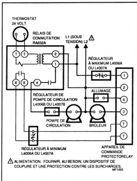
Fig. 5- Raccordement type d'un système de chauffage/refroidissement à allumage au mazout, avec eau chaude domestique, utilisant un L4006A ou B, L4007A ou B. Ce genre de raccordement est courant lorsqu'on ajoute un régulateur d'eau chaude domestique ou lorsque chaque régulateur Aqastat est monté à un endroit différent.
