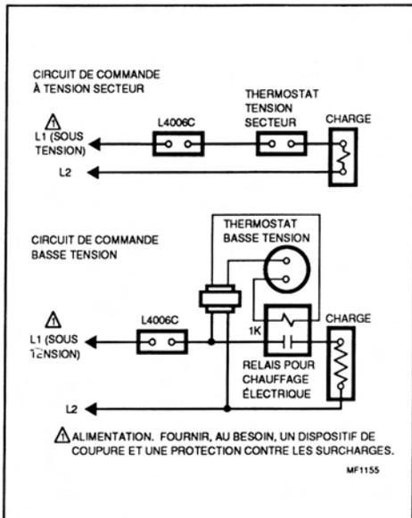
FIG. 6- Systèmes types avec appareils de commande à 120V utilisant le L4006C.
