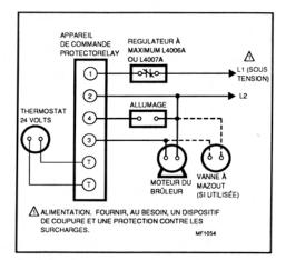
Fig. 4— Raccordement type d'un système à gravité à allumage au mazout et d'un L4006A ou L4007A.
