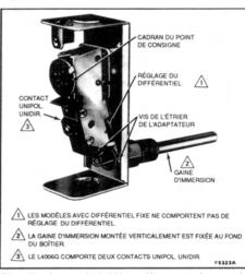
Fig. 1-Vue interne du L4006 (modèle avec gaine montée horizontalement)
