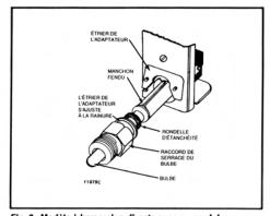
Fig. 3- Modèle à immersion directe avec raccord de serrage du buibe partiellement enlevé.
