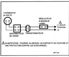
FIG. 8-Raccordement type d'un système au gaz 24 V utilisant un L4006C.
