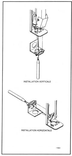
Fig. 2- Disposition du support de montage pour installation verticale ou horizontale
