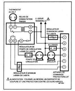
Fig. 5- Raccordement type d'un système de chauffage/refroidissement à allumage au mazout, avec eau chaude domestique, utilisant un L4006A ou B, L4007A ou B. Ce genre de raccordement est courant lorsqu'on ajoute un régulateur d'eau chaude domestique ou lorsque chaque régulateur Aquastat est monté à un endroit différent.
