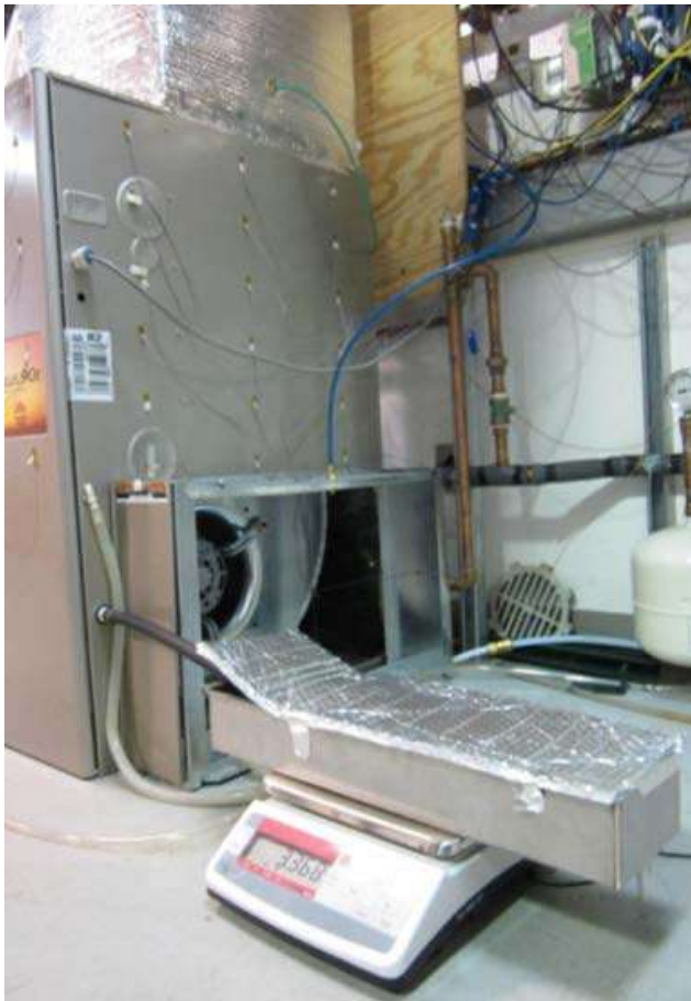
Figure 15. PARR AFUE lab testing
