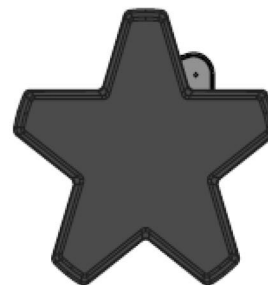
Posicionamiento correcto de la tapa del quemador
