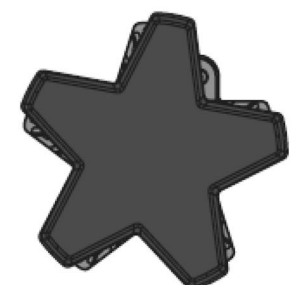
Posicionamiento incorrecto de la tapa del quemador
